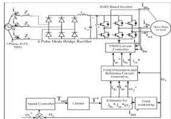
Fig. 1 Six-pulse diode rectifier fed VCIMD
