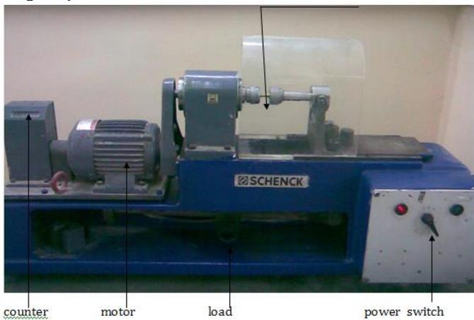
**Fig. 2 a. The fatigue-creep testing machine**
