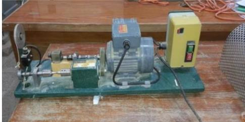
**Fig. (3): Fatigue test machine**
