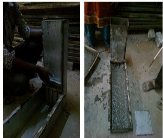
Fig 2. L- box test
