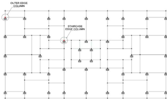
**Fig. h. Drawing Showing Location of Outer Edge and Staircase Edge Nodes.**
